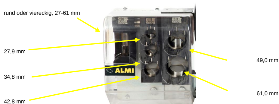
Abbildung 4.6-1: Rohrdurchmesser beim Ausklinken
